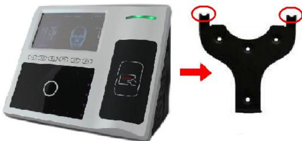
**3.** Por último, sujetamos el terminal colocando el tornillo en el hueco situado en la parte inferior del terminal.
