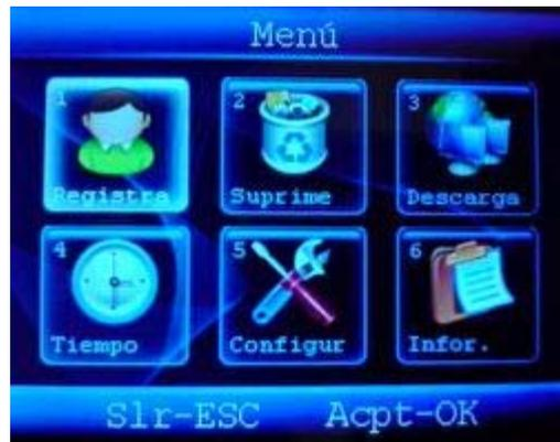
Para entrar en la configuración del sistema, seleccionamos la opción **"Configur"** y pulsamos la tecla **OK** o directamente la tecla 5 del teclado numérico. Nos aparecerá la siguiente pantalla:
