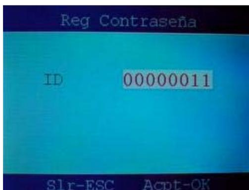
Seleccione el número de empleado (**ID**) mediante las flechas  $\blacktriangle$  o el teclado numérico y tras introducirlo pulse **OK**.
